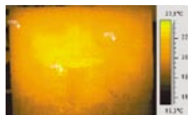
Rozložení povrchových teplot na omítané zdi s defekty přilnavosti při začátku chlazení (a) a po jedné hodině v laboratorních podmínkách s teplotou okolo 20 °C (b).
