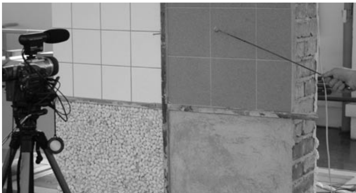
1. Zkušební stěna při poloautomatickém akustickém trasování.
