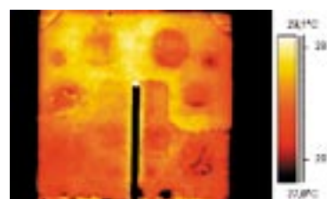
Rozložení povrchových teplot během přirozeného chlazení večerním chladným vzduchem po vyhřátí denní teplotou – stav po 45 minutách.
