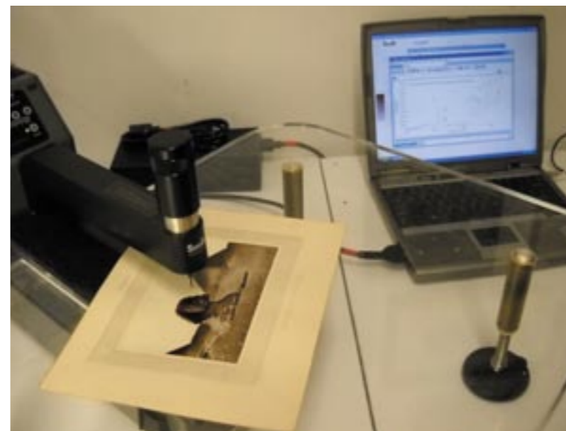
Obr. 2: Identifikace pojiva světlocitlivých látek – emulzní vrstvy fotografie – pomocí infračervené mikrospektroskopie v Getty Conservation Institute, Los Angeles, USA. (foto Petra Vávrová)
