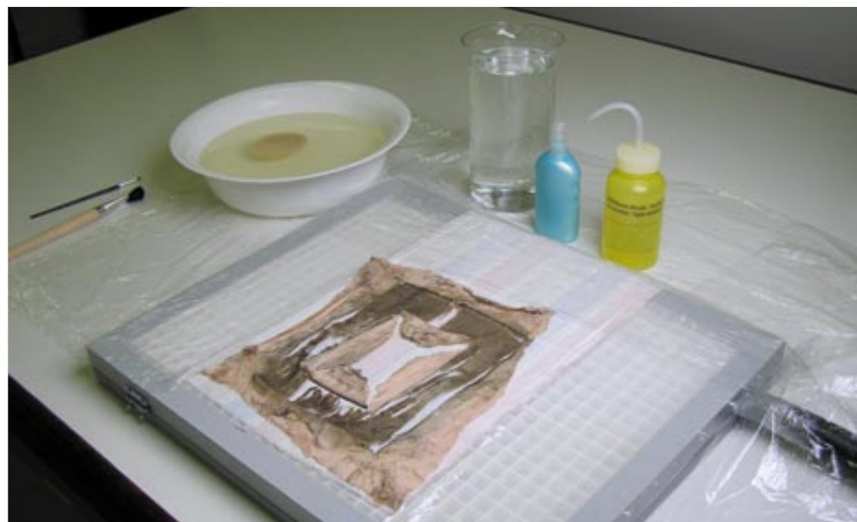
Obr. 4 Šetrné čištění velmi poškozené hedvábné tkaniny na stole se spodním odtahem, foto: V. Šulcová
