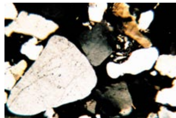
Obr. 11: Výbrus vzorku z kamenného kvádru Karlova mostu v Praze (foto Z. Štafen)
