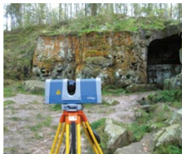
Obr. 15: Reliéf Klanění králů z Betléma v Novém lese u Kuksu, dokumentace 3D laserovým skenerem, Handy Scan (foto M. Dvořák)
