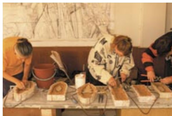
Obr. 12: Dvůr Králové nad Labem, náměstí T. G. Masaryka č. p. 57, výroba nových dílenských prvků štukové výzdoby (foto J. Kašpar)
