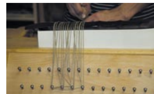
Obr. 14. Vyvazování hřbetu bloku. Foto Radomír Slovík.
