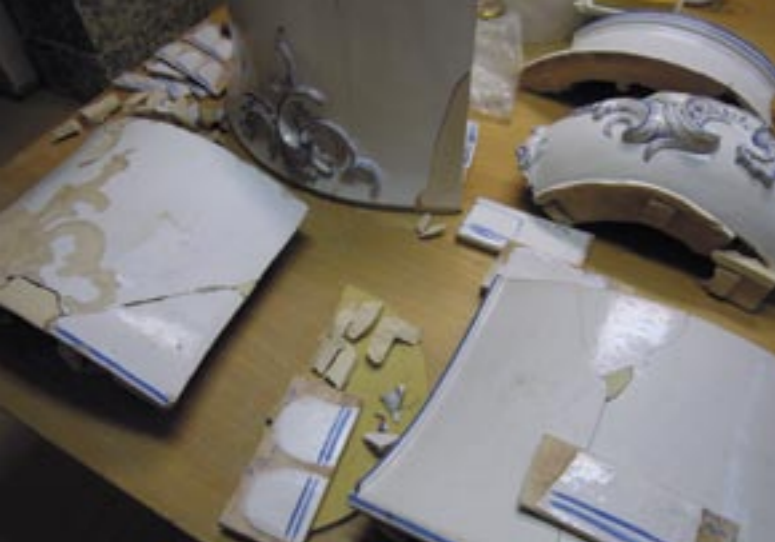
Obr. 8. Zkušební přisazování nově vytvořených částí k neorokokovým kachlům. Barevný odstín glazury se u jednotlivých originálních kachlů lišil. Proto byly při glazování nových replik používány různé variace základní namíchané glazury, aby výsledný odstín korespondoval s originálem. Foto Sylva Antony Čekalová.
