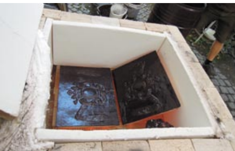
Obr. 3. Výroba replik celých nedochovaných kachlů – výpal v plynové peci technikou Raků. Po dosažení požadovaného vytavení glazury je při teplotě cca 1000°C pec otevřena a ještě žhavé kachle jsou připravené k vyjmutí a vložení do pilin. Foto Sylva Antony Čekalová.
