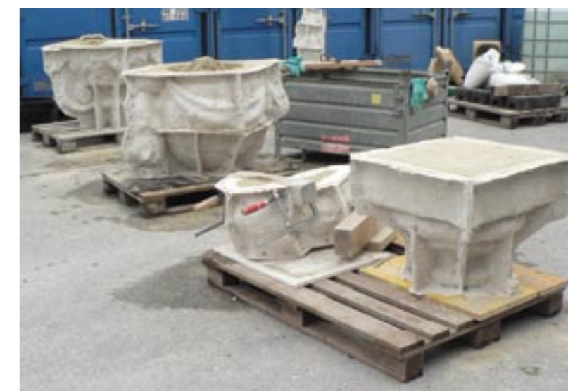
Obr. 5. Formy během dusání. Foto Josef Čepelka.
