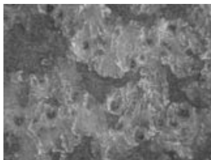
Obr. 2 – mikroskopický detail poškození mramorované usně
