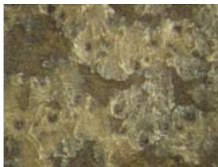
Obr. 2 – mikroskopický detail poškození mramorované usně
