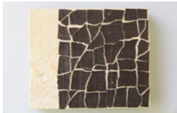
Obr. 5 Testovací pole s uměle vytvořenými krakely.
