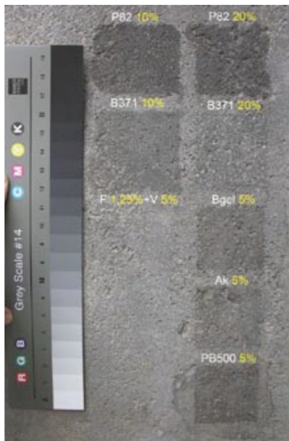
Obr. 10 Zkoušky vybraných adheziv na bloku kamene s poškozenou barevnou vrstvou.
