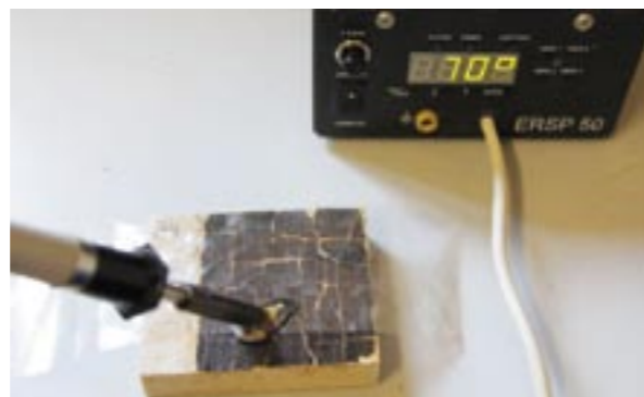
Obr. 6 Zažehlování umělých krakel pomocí adheziva přes melinexovou fólii tepelnou špachtlí s regulovaným ohřevem.
