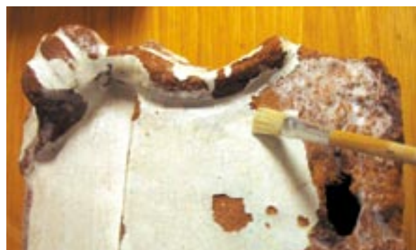
Obr. 7 Nanášení roztoku štětcem na nesoudržný střep.
