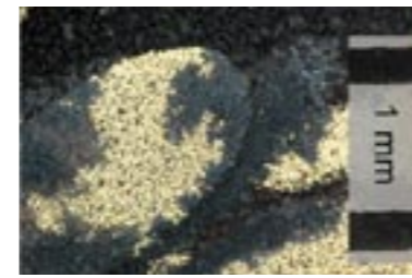
Figure 17 Corrosion products silver underdrawings overgrowing the golden decoration. © Schloß Schönbrunn Kultur- und Betriebsges.m.b.H. / Silvia Miklin-Kniefacz, Institut für Konservierung und Restaurierung; Sammlung Bundesmobilienvverwaltung.
