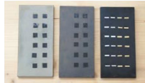
Figure 23 Test boards for defining a suitable consolidation medium, with lacquer on foundation (right), lacquer on foundation with isolation of the foundation (middle) and Kirikane on a finished lacquer surface (left). © Schloß Schönbrunn Kultur- und Betriebsges.m.b.H. / Silvia Miklin-Kniefacz, Institut für Konservierung und Restaurierung; Sammlung Bundesmobilienvverwaltung.
