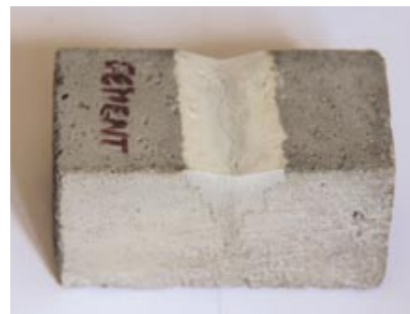
Obr. 6 Ilustrační foto, zkouška injektážní výplňové směsi
